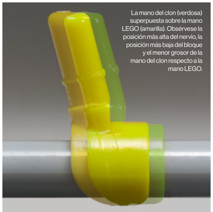
Una mano LEGO, a la izquierda, y la mano del clon, a la derecha. Esta mano LEGO en concreto presenta un extremo inclinado en la barra, dígitos en la cara dorsal del bloque angular de la muñeca y dígitos en la barra entre el bloque de la muñeca y el nervio, en la cara ventral.
