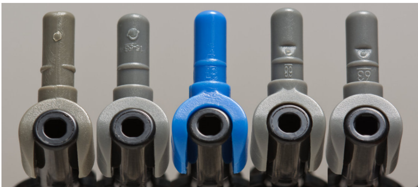
Cara dorsal arriba, cara ventral abajo. Manos LEGO correspondientes a distintas iteraciones del molde.
